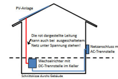
Abb. 2: Anbringung des Warnleibers am Wechselrichter (gemäss NIN 2020)
