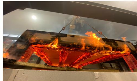
Brandversuch - Prüfkörper nach 60 min.
